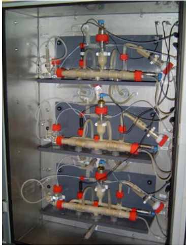
Het TNO in vitro model van de dikke darm, met daarin een fysiologische hoeveelheid microorganismen (10 10 /mL), die het metabolisme van de microbiota in de menselijke darm nabootst.
